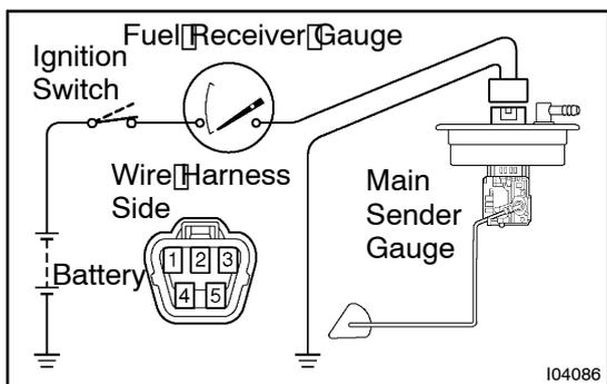
**7. INSPECT FUEL RECEIVER GAUGE OPERATION**
