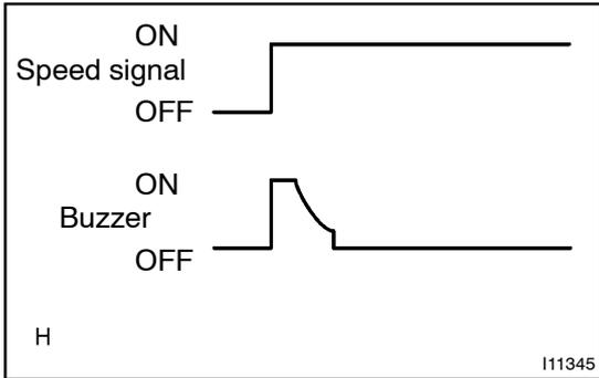
**34. INSPECT PARKING BRAKE WARNING BUZZER**
