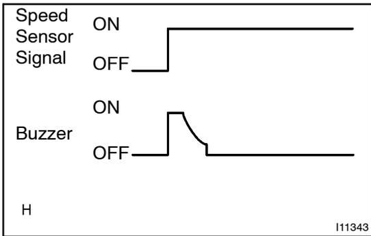
**33. INSPECT OPEN DOOR WARNING BUZZER**
